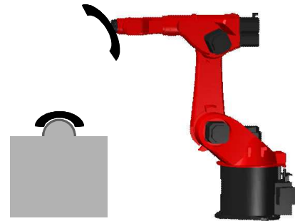
Preforming Umformen des textilen Halbzeugs
