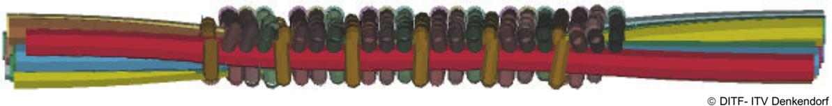
**Abb. 8: Simulation der Gewebeherstellung von 6 Köper 3/1-Z-Rapporten mit Einbindung von 16 Schussfäden, Seitenansicht**
